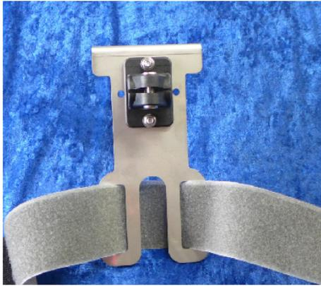
Mit den zwei M5 Schrauben wird die Flanschklemme am Flaschenhalter befestigt. Ich empfehle bei der Verwendung unseres Gestells die Montage für ein horizontales Rohr. Achtung: Eventuell macht es Sinn, zunächst die Flanschklemme am Gestell zu befestigen (sofern man eins besitzt) und erst später den Flaschenhalter daran zu befestigen.
