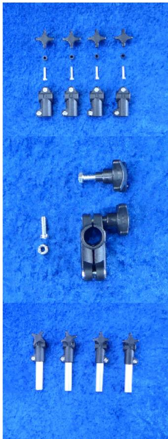
**Schritt 4:** Montage der Schwenkklemmen. Hierfür benötigt man 4x Schwenkklemme; 12x Klemmgriff; 12x Hülse; 12x Schraube M6x25;
