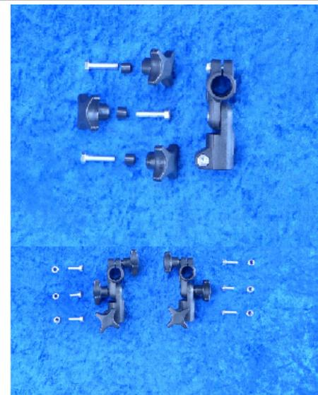
**Schritt 5:** Jetzt werden alle Klemmen montiert. Zunächst wird die Schwenkklemme auf die Querholme gesetzt, sodass sich die beiden Klemmen (Schwenkklemme und T-Klemme des jeweiligen Längsholms) berühren. Jetzt können die T-Klemmen fixiert und auch die Schwenkklemmen befestigt werden.
