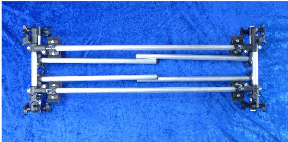
Oben sieht man die fertige Felsenspinne in Transportstellung. Unten ist die Felsenspinne aufgebaut. Man beachte die Position der Schwenkklemmen!
