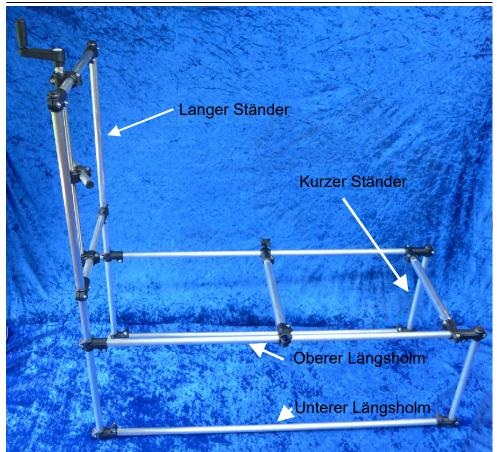
**Schritt 5:** Jetzt werden die beiden Hälften zusammen gesetzt. Man sollte dabei hinten, also am Kurbelantrieb beginnen. Beachten sie die nötige Lage des Kurbelantriebs (Klemme mit kurzem Querholm ist am weitesten hinten! Auf dem Bild ist das leider genau falsch herum!).
