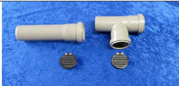
Hier nochmal die Übersicht, in welche Rohrstücke die Ventile eingebaut werden sollen. Bei der Variante mit zwei Ventilen pro Saugrichtung, sind nochmal zwei kurze Rohrstücke mit dabei, die analog einzubauen sind. Achten Sie bitte auch auf die Einbaurichtung! Die Ventile sollten jeweils nach vorne öffnen. Gebrauchte Rohre vorher reinigen!
