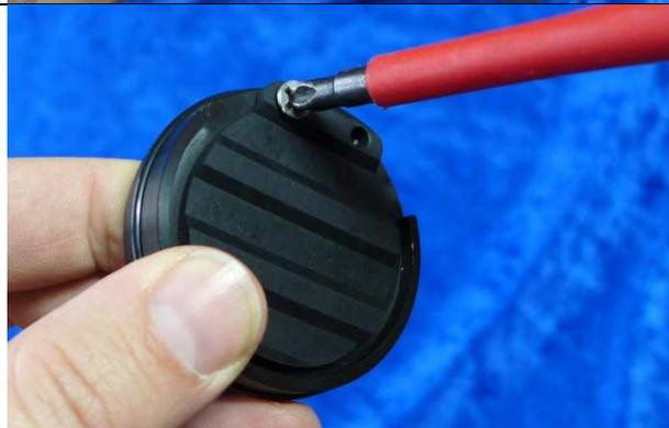
Als nächstes werden die Ventile montiert. Zuerst schieben wir den O-Ring in die vorgesehene Nut an der Seite des schwarzen Ventilkörpers. Dann schrauben wir mit einem P2-Kreuzschraubenzieher die Ventilklappe auf die Vorderseite. Dabei ist darauf zu achten, dass die Ventilklappe schön mittig sitzt und zum Rand auf jeder Seite denselben Abstand hat. Die Schraube soll die Ventilklappe nur fixieren und nicht zerquetschen!
